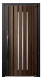
扉枠は、デットボルト（かんぬき）が入るところが補強され、バーなどによるこじ破りに強い。ドア面材も、ドリル攻撃や切り破り攻撃に対する強化がなされ、錠は主錠（鎌式デッドbolt）および補助錠（上部ロット棒含む）の組合せによる2ロックです。室内側のサムターンは着脱式が装備されています。
